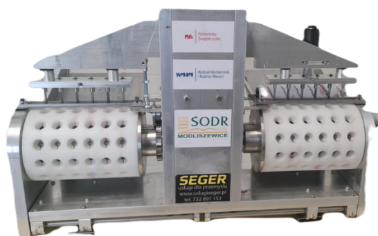
Rys. 67. Zestawienie modelu 3D i zbudowanego prototypu drylownicy
