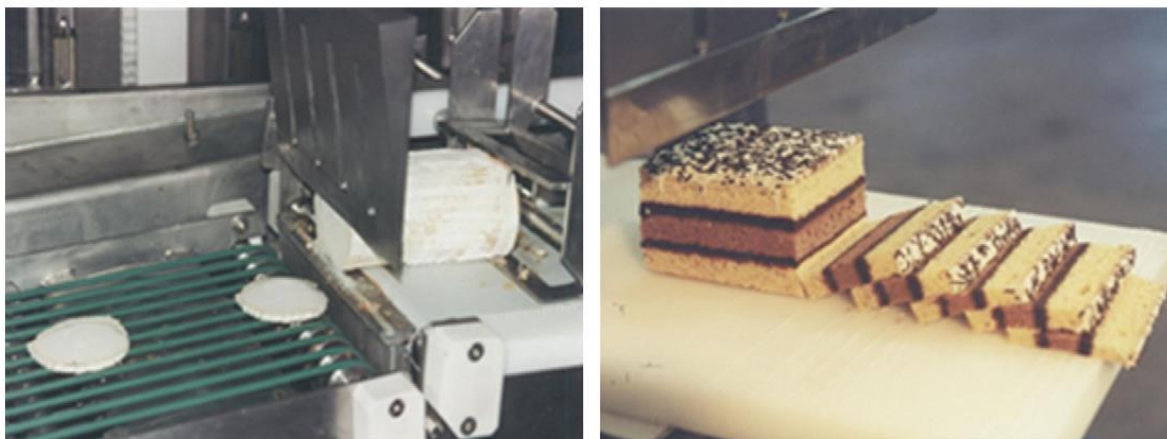
Rys. 19. Różnica w krojeniu kromek pieczywa krojonego z i bez ultradźwięków [43]
