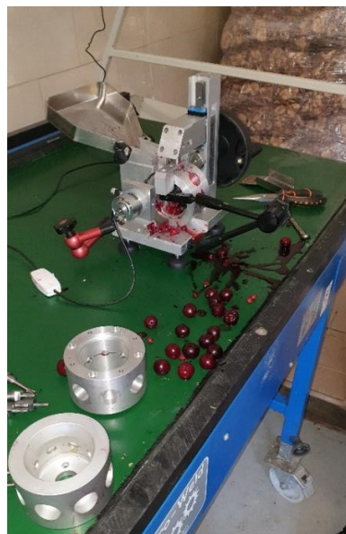
Rys. 57. Widok procesu testowania procesu drylowania
