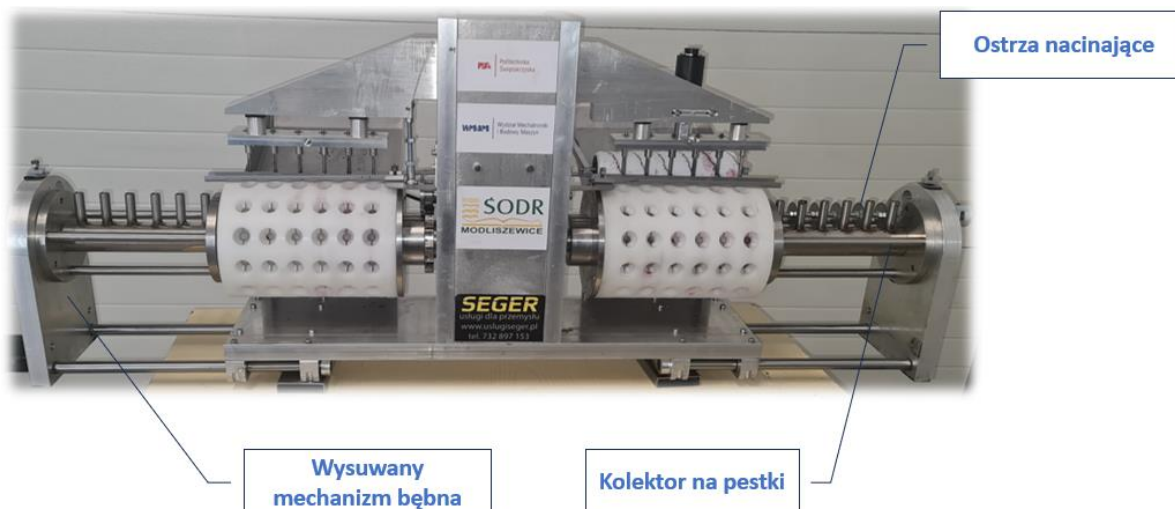
Rys. 69. Opis cech użytkowych złożonego prototypu drylownicy
