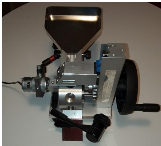
Rys. 51. Widok z góry wykonanego urządzenia do testowania procesu drylowania
